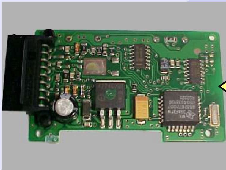
Visualizando a placa de circuito do Imobilizador GM Opel 2
